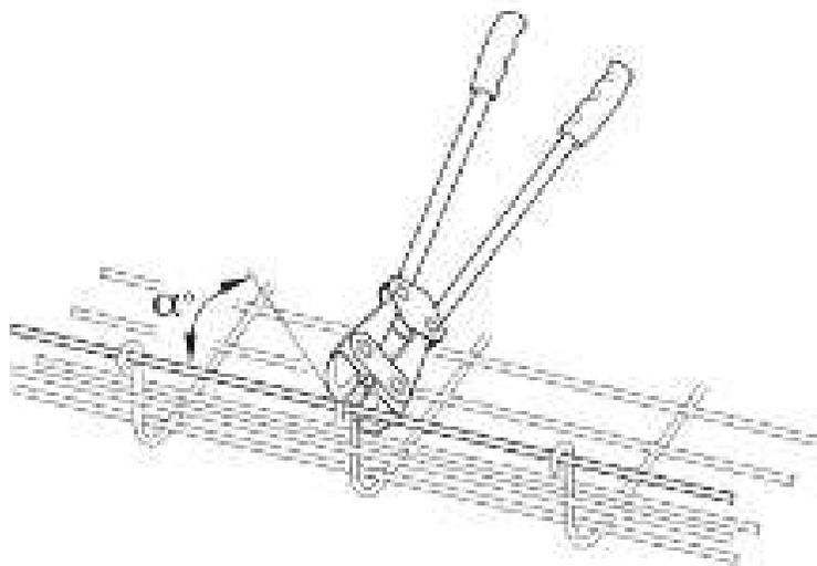
El corte realizado con esta pinza garantiza protección galvánica hasta el punto de corte. Inicialmente, las hojas asimétricas aplastan el material y después lo cortan con un espesor de aproximadamente 1/2 mm. Gracias a la migración de las partículas de zinc de la superficie se obtiene una protección total.
