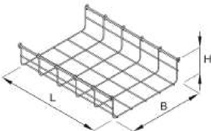
Cortar los hilos de la base y de un sólo lado con la pinza (como se muestra en la figura) y retire el número de partes P indicado en la tabla.
