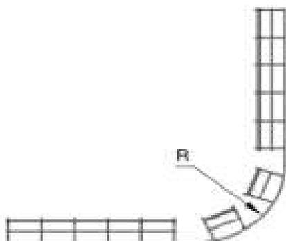
Si se realizan varios cortes sobre la longitud de la bandeja se puede realizar, además, la superación de obstáculos en el recorrido
