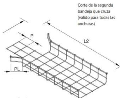
Unir las dos partes respetando las posiciones de los tornillos y de las placas, cómo se ilustra.
