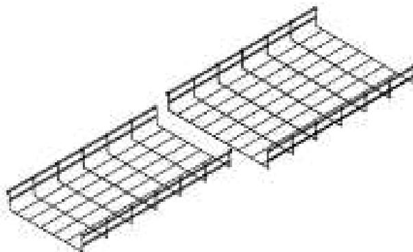
Acoplamiento: en la parte de las orejas, se coloca el clip ED-275 acoplado con 3 juegos clemas pequeña con tornillo milimétrico. Adicionalmente en la cama de la charola, se pondrán 2 juegos de clemas mediana, clemas pequeñas y tornillo con tuerca.
