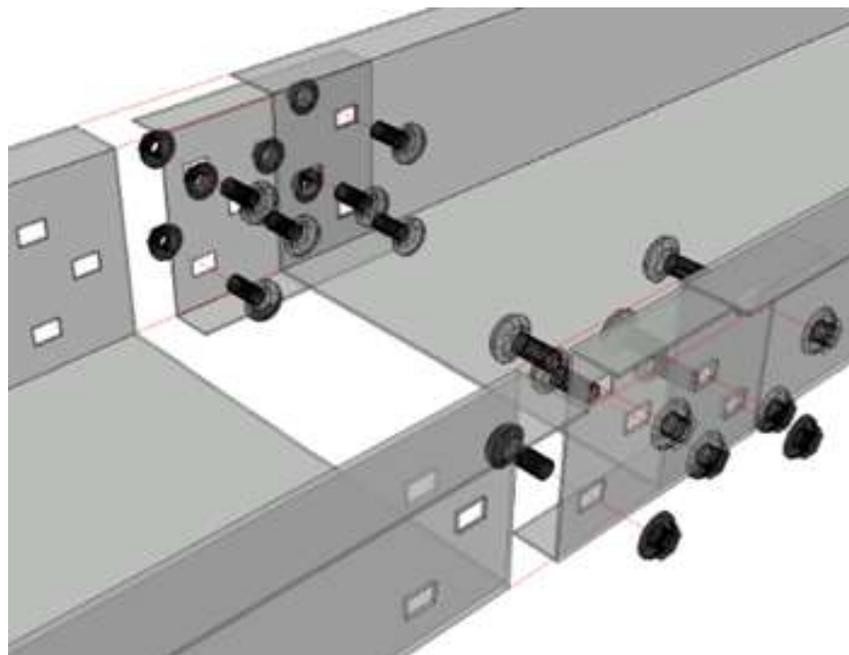
Las dos piezas que se estén uniendo deben de quedar lo mas juntas posible y evitar la entrada o filtración de elementos externos.
