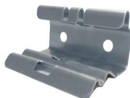
El Clip Automático se puede instalar a presión o con la ayuda de un desarmador introduciendo el mismo en el orificio de la junta y girar hasta el enganche en el fondo de la charola.
