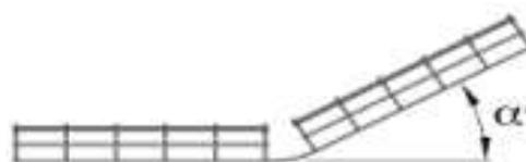
Para realizar curvas en subida o bajada con radios de curvatura más amplios, corte dos o más partes laterales.
