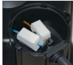
HelaCon Lux conectado a la fuente de alimentación.
