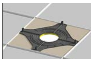
2. Corte la placa de techo.
