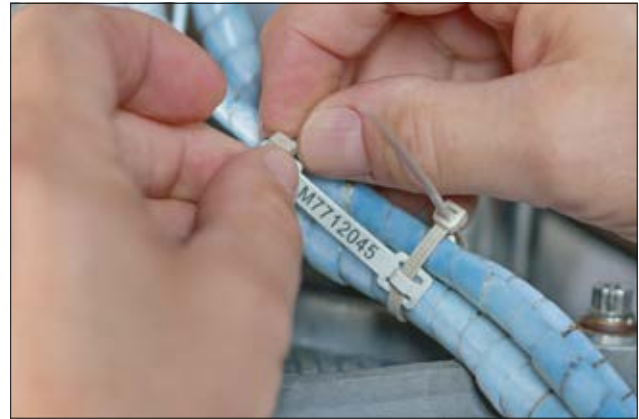
Bridas de dentado exterior y placa de identificación HFTP48 fabricadas de Peek.
