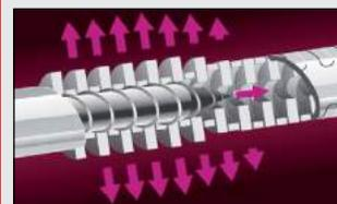
En bases de anclaje macizas funcionan por presión de expansión.
